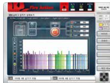
아날로그감지기 상태 표시
